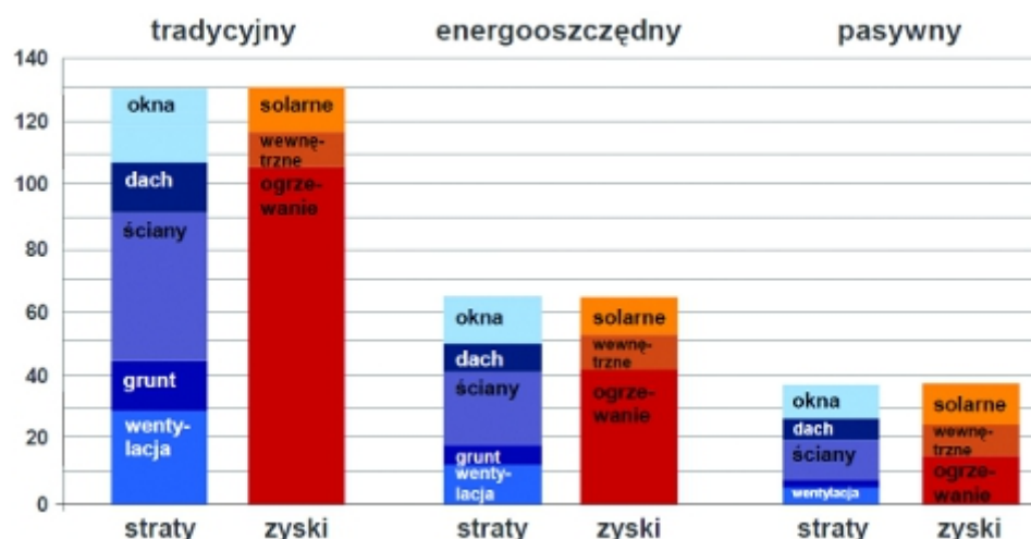
Rys. 1. Bilans energetyczny budynku tradycyjnego, energooszczędnego i pasywnego
