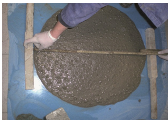
Fot. 3. Pomiar wielkości rozprywu mieszanki betonowej samozagęszczalnej wg PN-EN 206
