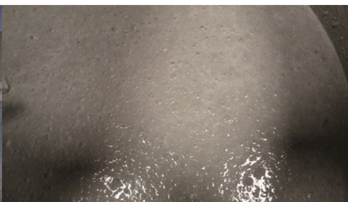
Fot. 4. Widok mieszanki betonowej samozagęszczalnej o dużej płynności
