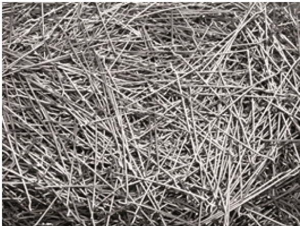
Fot. 6. Włókna stalowe i polimerowe stosowane do betonu ze zbrojeniem rozproszonym - fibrobetonu
