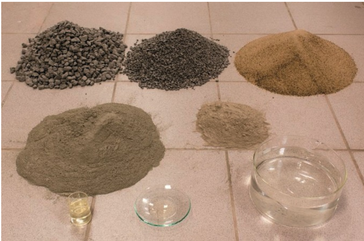
1. Przykładowy skład betonu mostowego (fot. K. Ziętkowski)
