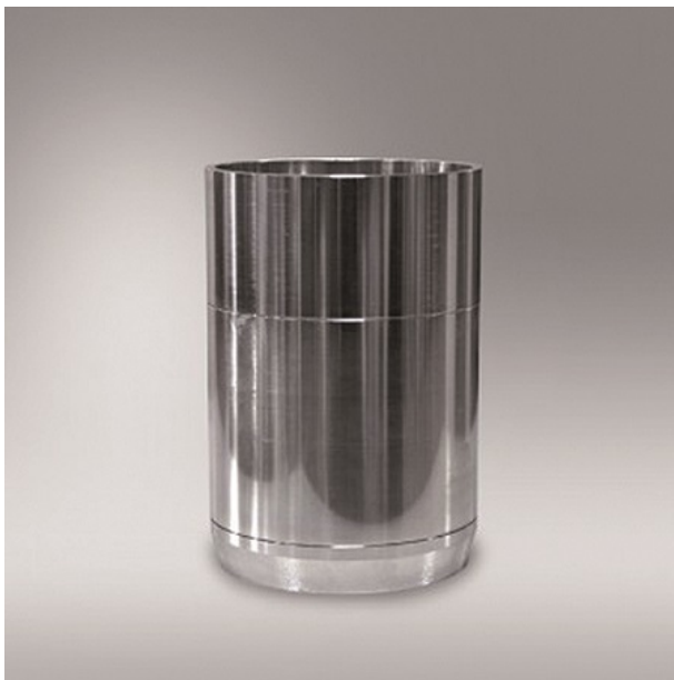
Fot. Cylinder o stałej objętości [8]
