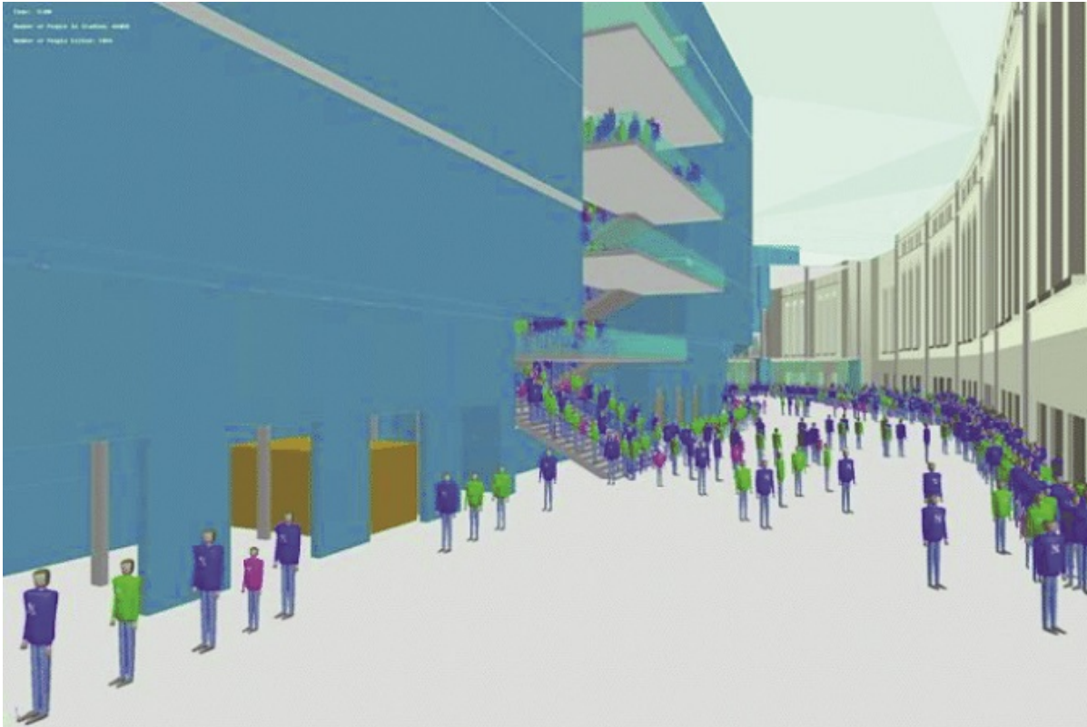
5. Zastosowanie BIM 8D do modelowania drogi ewakuacyjnej [11]
