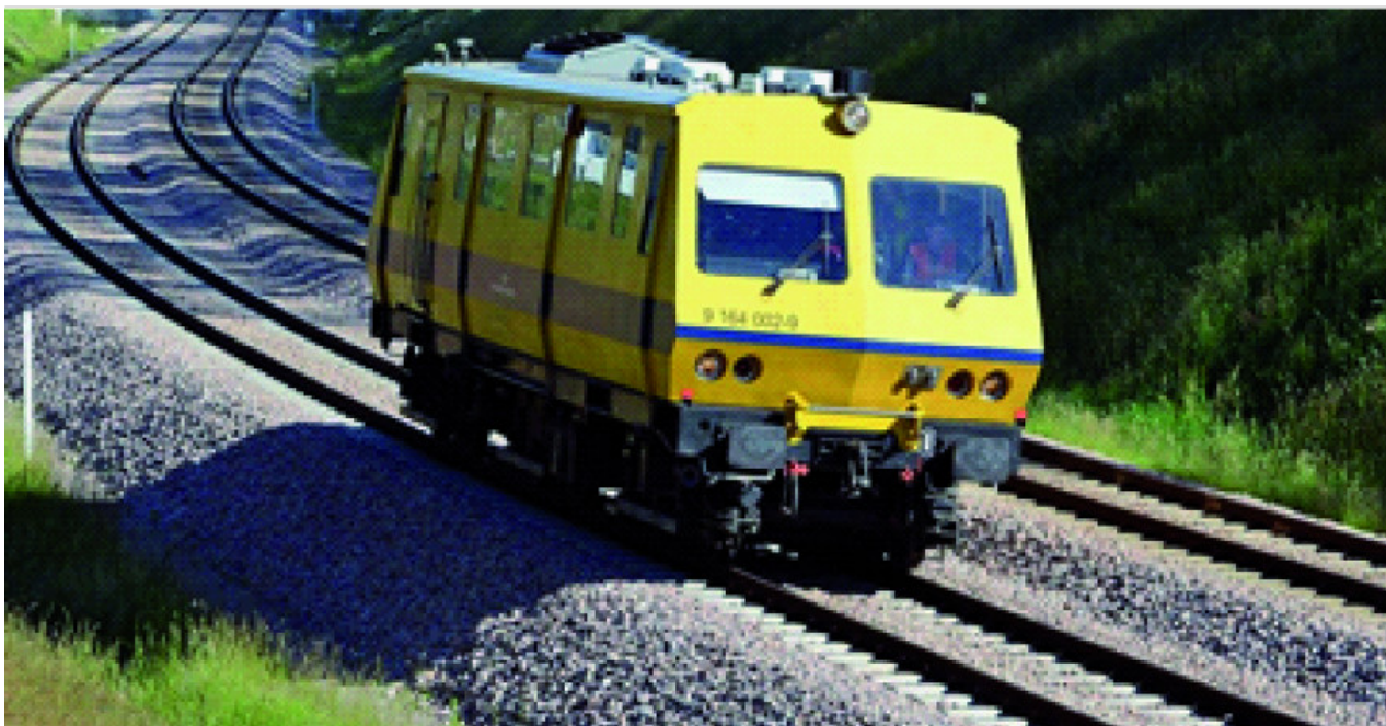
Fot. 1. Przyrządy i urządzenia pomiarowe do badań diagnostycznych stanu geometrycznego toru:
