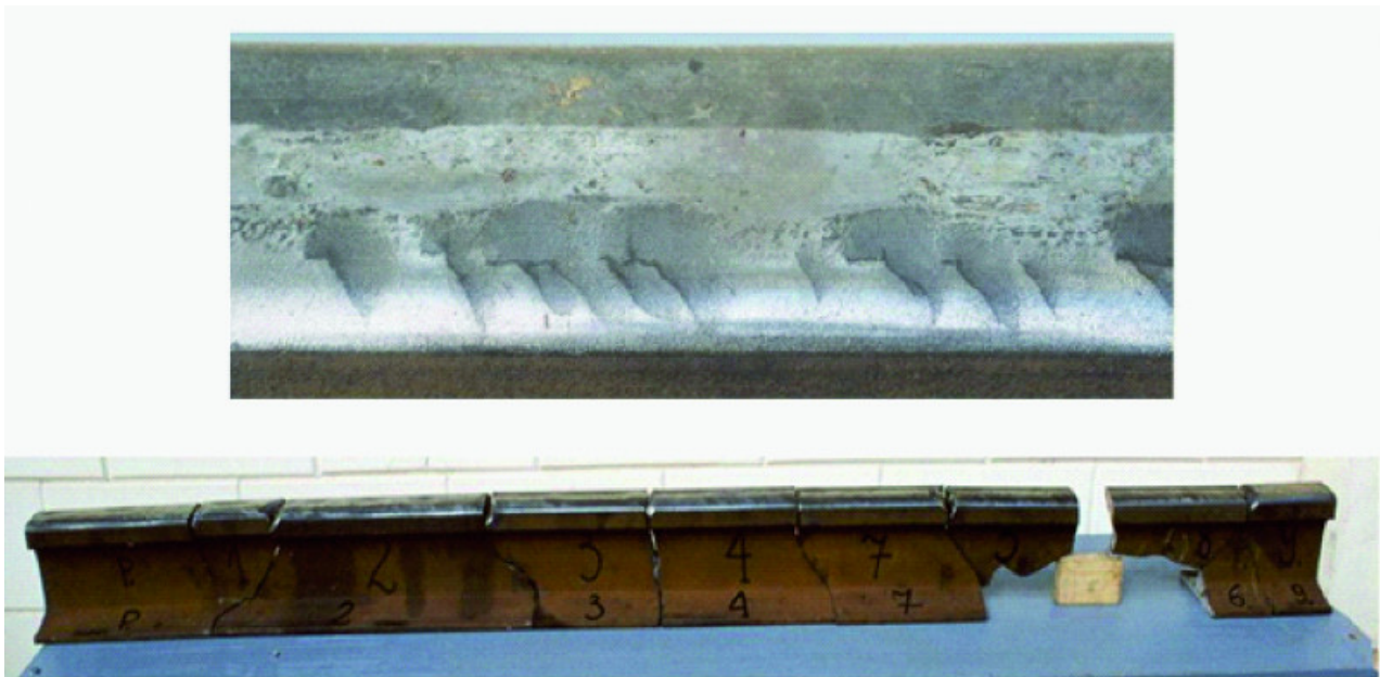
Fot. 4. Przykład wad kontaktowo-zmęczeniowych na powierzchni tocznej szyny oraz widok wielokrotnego spękania szyny [7]
