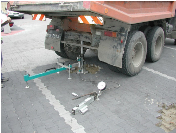
Fot. 2. Przykład badania VSS w terenie wg PN-S-02205
