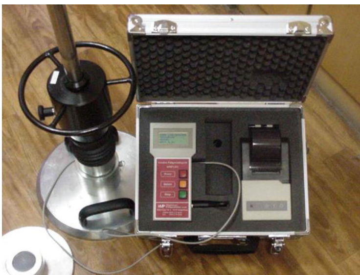
Fot. 3. Przykładowy zestaw do badania płytą dynamiczną
