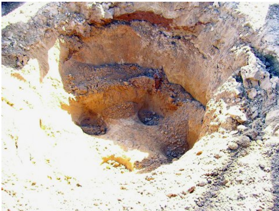
Fot. 4. Widok krateru wybitego przez spadający ciężar
