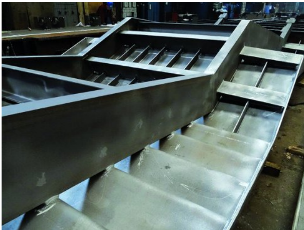
Fot. 3. Fragment kładki z wieloma miejscami trudno dostępnymi dla zabezpieczeń antykorozyjnych (fot. A. Kaleta)
