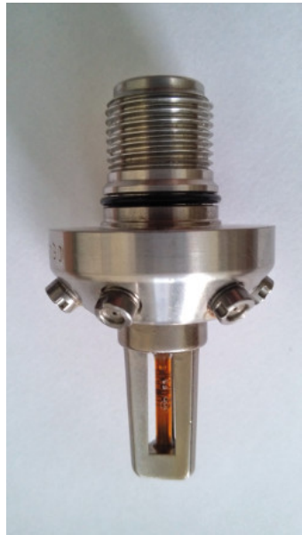
Fot. 2. Głowica mgłowa zamknięta. Źródło: archiwum CNBOP-PIB
