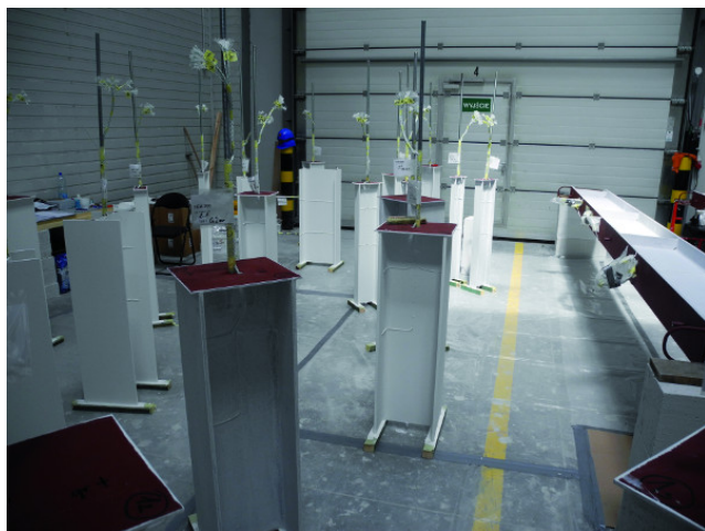
Fot. 11. Przygotowanie elementów stalowych do badania skuteczności zabezpieczenia ogniochronnego farbą pęczniejącą. Autor: archiwum ITB
