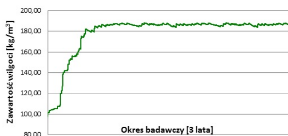
Rys. 2. Przykład przyrostu zawilgocenia w ścianie ceglanej ocieplonej od strony wewnętrznej - cegła pełna
