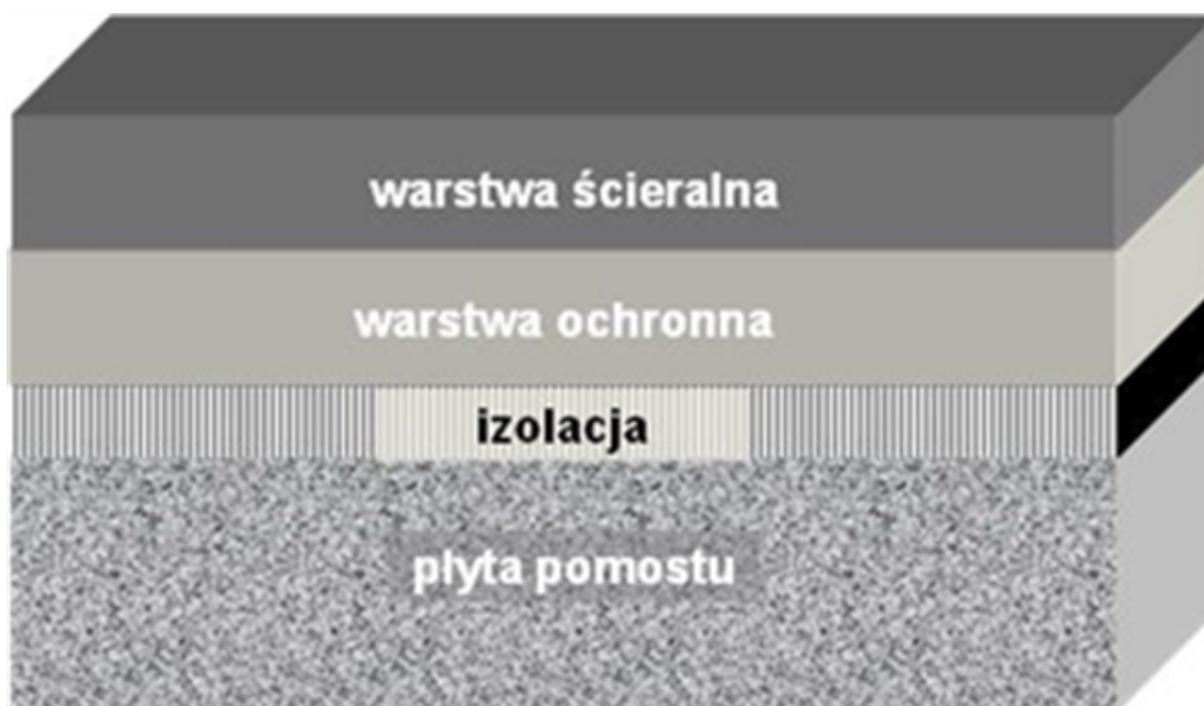
Rys.1. Układ warstw konstrukcji nawierzchni na pomoście mostowym
