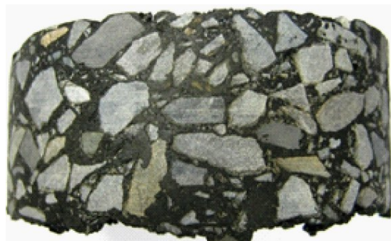
Rys. 6. Szkielet mineralny w mastyksie grysowym SMA 11
