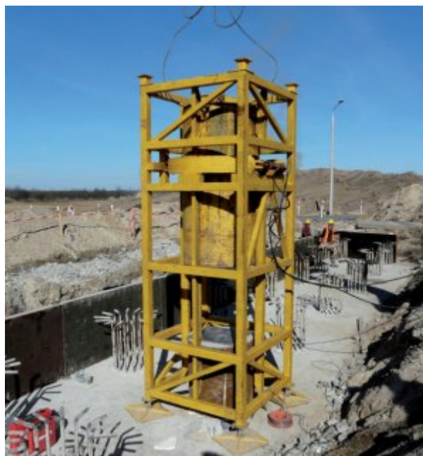
Fot. 7. Czujniki do pomiaru odkształceń i przyspieszeń w badaniu dynamicznym pala
