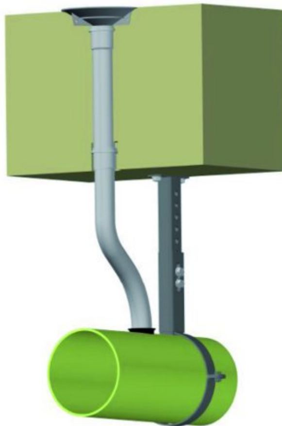
Rys. 5. Podłączenie sączka do kolektora zbiorczego z zastosowaniem rury giętkiej
