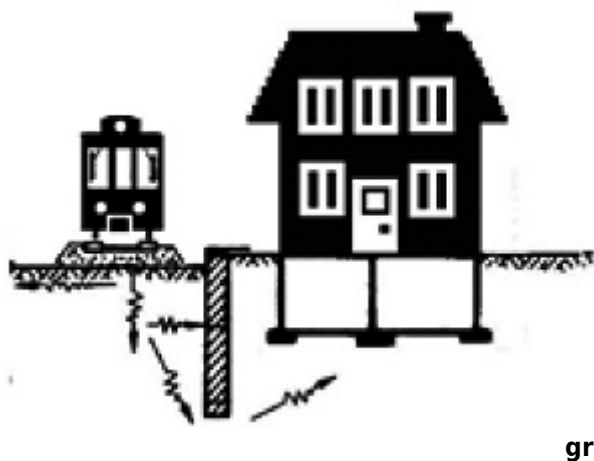
Rys. 14. Schemat przegrody wibroizolacyjnej w
