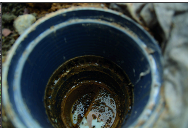
Fot. 2. Zakamieniony pierścień „przedłużki” (fot. autora)
