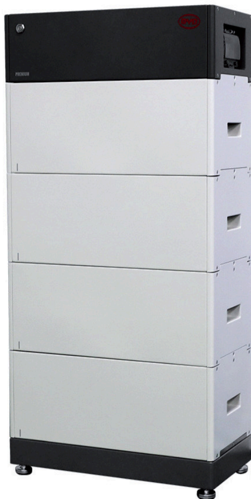
Fot. 6. Bateria akumulatorów NMC 409 V o dostępnej pojemności energii 10,2 kWh [8]
