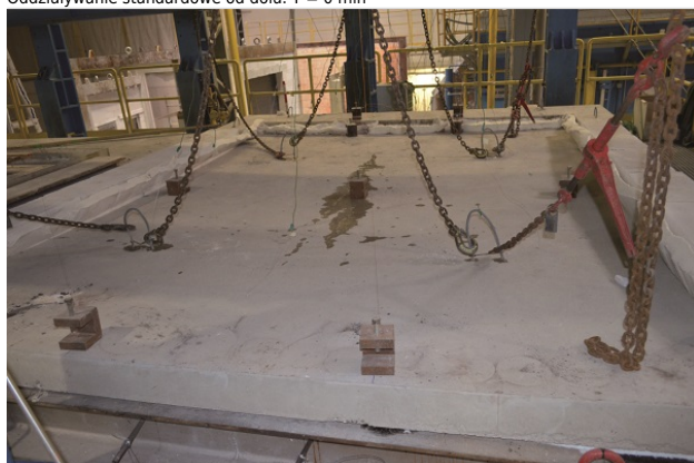
Fot. 2b. Strona nienagrzewana żelbetowej płyty o grubości 15 cm. Oddziaływanie standardowe od dołu. T = 30 min
