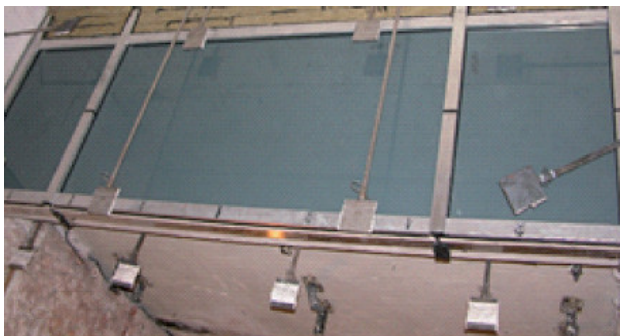
Fot. 5. Pas międzykondygnacyjny, częściowa konfiguracja, krzywa standardowa N: a) strona od zewnątrz przed badaniem, b) strona od zewnątrz po badaniu
