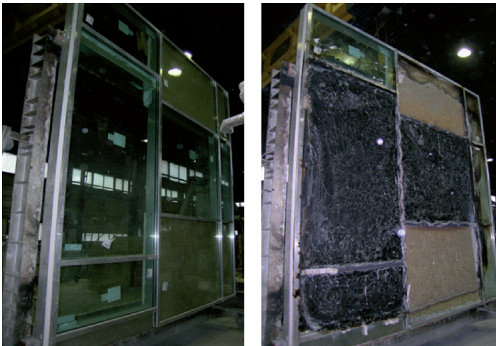
Fot. 7. Ściana słupowo-ryglowa nagrzewana od zewnątrz: a) przed badaniem, b) po badaniu
